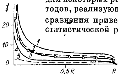
Рис. 25. Усиление случайной ошибки эксперимента в различных методах решения уравнения Абеля (при размерности вектора решения n = 40 ).
